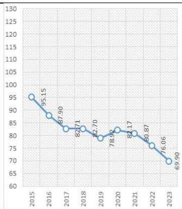
Figura 4.4 Trendi i intensitetit për të gjithë stokun e ndërtesave (aktualisht të banuara dhe të pabanuara) të sektorit të banimit (duke marrë parasysh konsumin total të energjisë për banesa), kWh/m 2 ·vit
